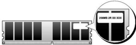
➡ **AVISO:** No instale módulos de memoria ECC. Estos módulos pueden impedir que el sistema se inicie o bien afectar a su rendimiento.
